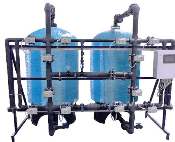
► Hệ lọc tổng công suất 30 m 3 /h
