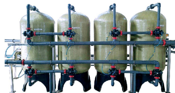
► Hệ lọc tổng công suất 50 m 3 /h
